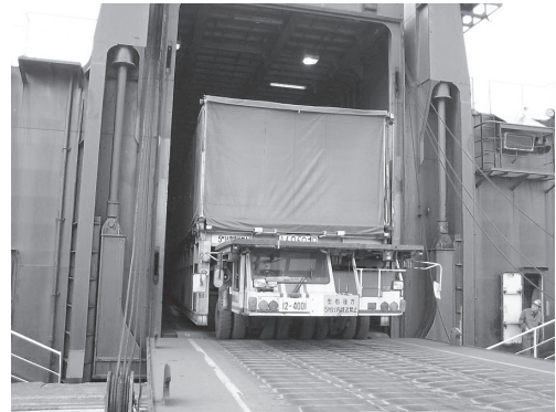
写真4 特殊車両にて船内にパレットを積み付けするタイプの特殊船の荷役
