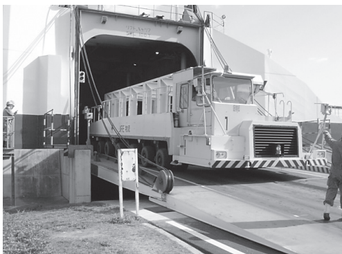
写真2 移載機にて船内にパレットを積み付けするタイプの特殊船の荷役
