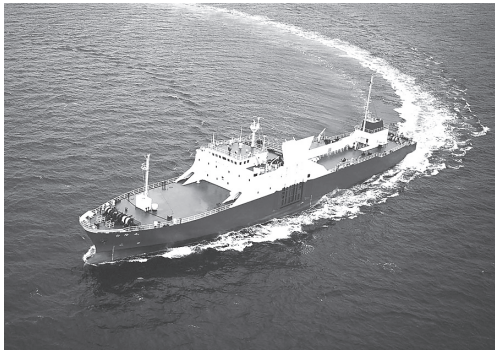
写真1 移載機にて船内にパレットを積み付けするタイプの特殊船
