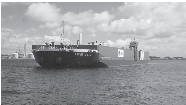
写真3 特殊車両にて船内にパレットを積み付けするタイプの特殊船
